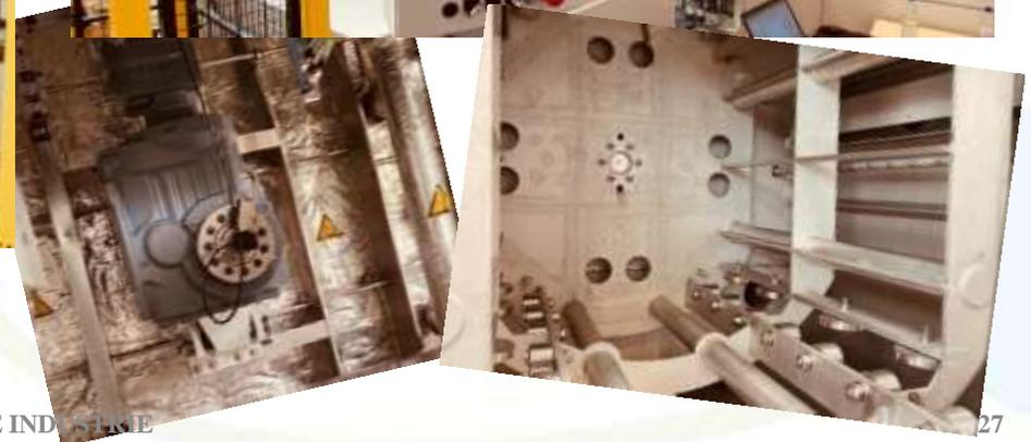
**MACHINE ROLL A 3 BAINS** par aspersion avec panier tournant en axial et charge de 500 Kg pour la société INTERFRAP LAVAGE
