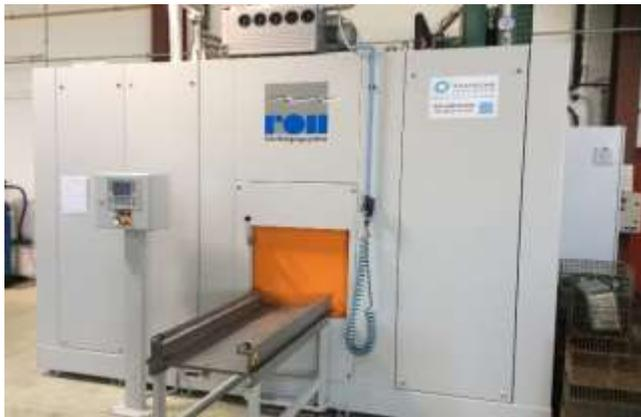
Machine de nettoyage-dégraissage ROLL RCTS 120 avec 2
