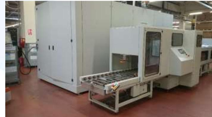
Machine de nettoyage-dégraissage ROLL RCTS 067 avec 2 bains de nettoyage et un bain de dégraissage STREIT Mécanique au solvant Non Chlore DOWCLENE 1601
