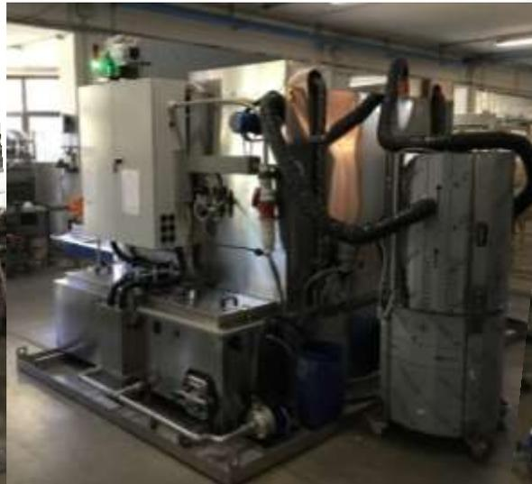
**MACHINE SIMPLEX 1800-2 BAINS avec panier rotatif**
