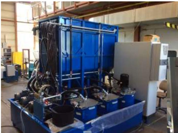
Installation centralisée de filtration d'huile de frappe avec 3 centrifugeuses manuelles S15 et U15
