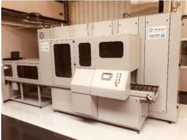
Machine de nettoyage-dégraissage
