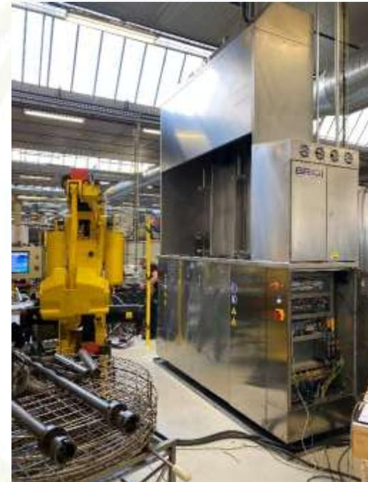
Cuve ultra sons en multi cuves avec ROBOTISATION
