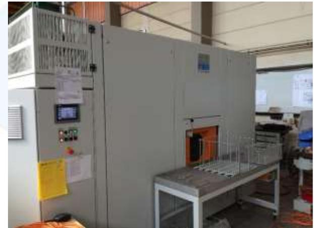
Machine de nettoyage-dégraissage ROLL RCTS 50 avec 2
