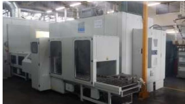
Machine de nettoyage-dégraissage ROLL RCTS 067 avec 2 bains de nettoyage « FONDEX » au solvant Non Chlore DOWCLENÉ 1601
