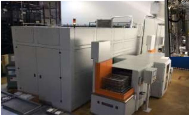
Machine de nettoyage-dégraissage ROLL RCTS 067 avec 2 bains de nettoyage et 2 bains de regraisage « BORG WARNER » au solvant Non Chlore DOWCLENE 1601
