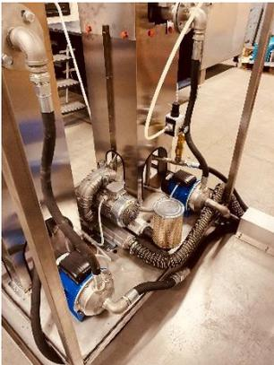
Vue des système de pompe renforcée avec filtration
