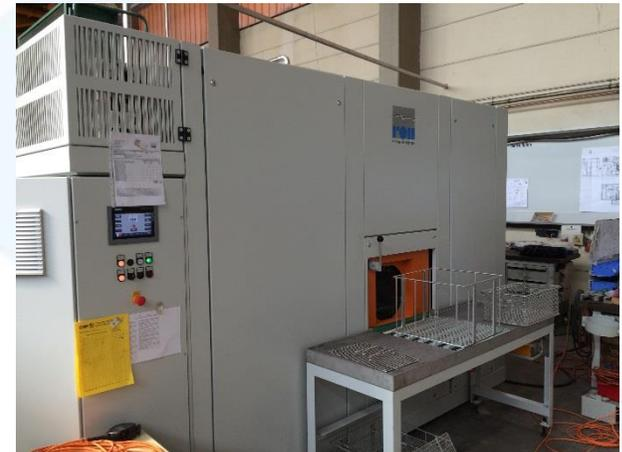
Machine de nettoyage-dégraissage ROLL RCTS 50 avec 2 bains de nettoyage
