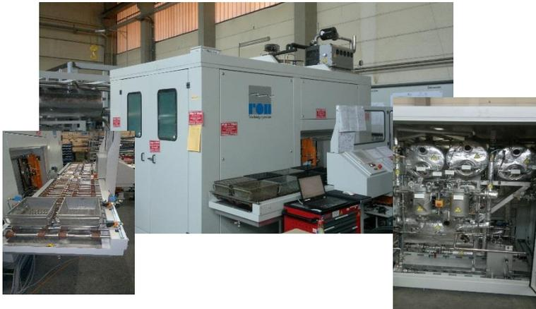
Machine de nettoyage-dégraissage ROLL RCTS 048 avec
