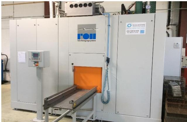
Machine de nettoyage-dégraissage ROLL RCTS 120 avec 2 bains de nettoyage
