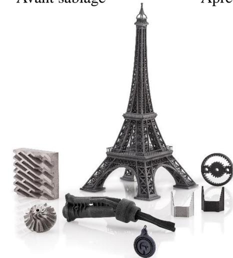
Exemple de pièces sable après fabrication additive
