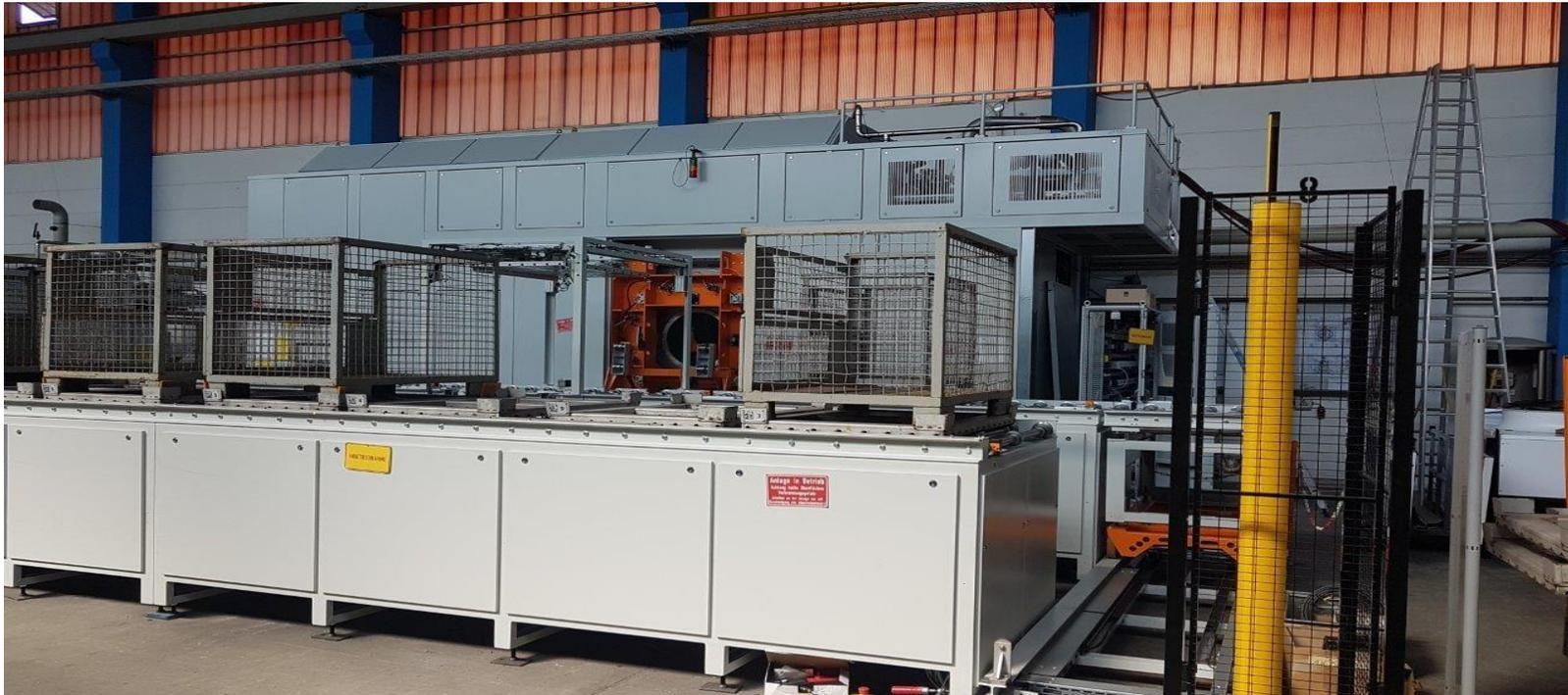
Machine de nettoyage-dégraissage ROLL RCTS 120 \* 090\*097
