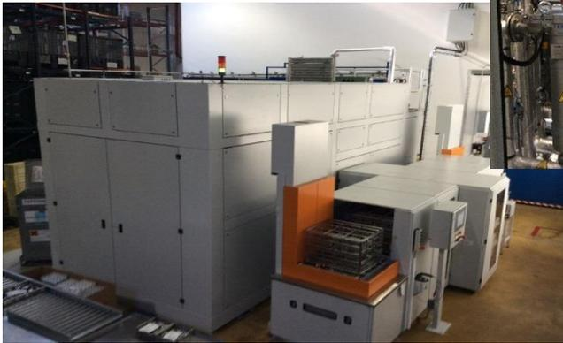
Machine de nettoyage-dégraissage ROLL RCTS 067 avec 2 bains de nettoyage et 2 bains de regraissage « BORG WARNER » au solvant Non Chlore DOWCLENE 1601
