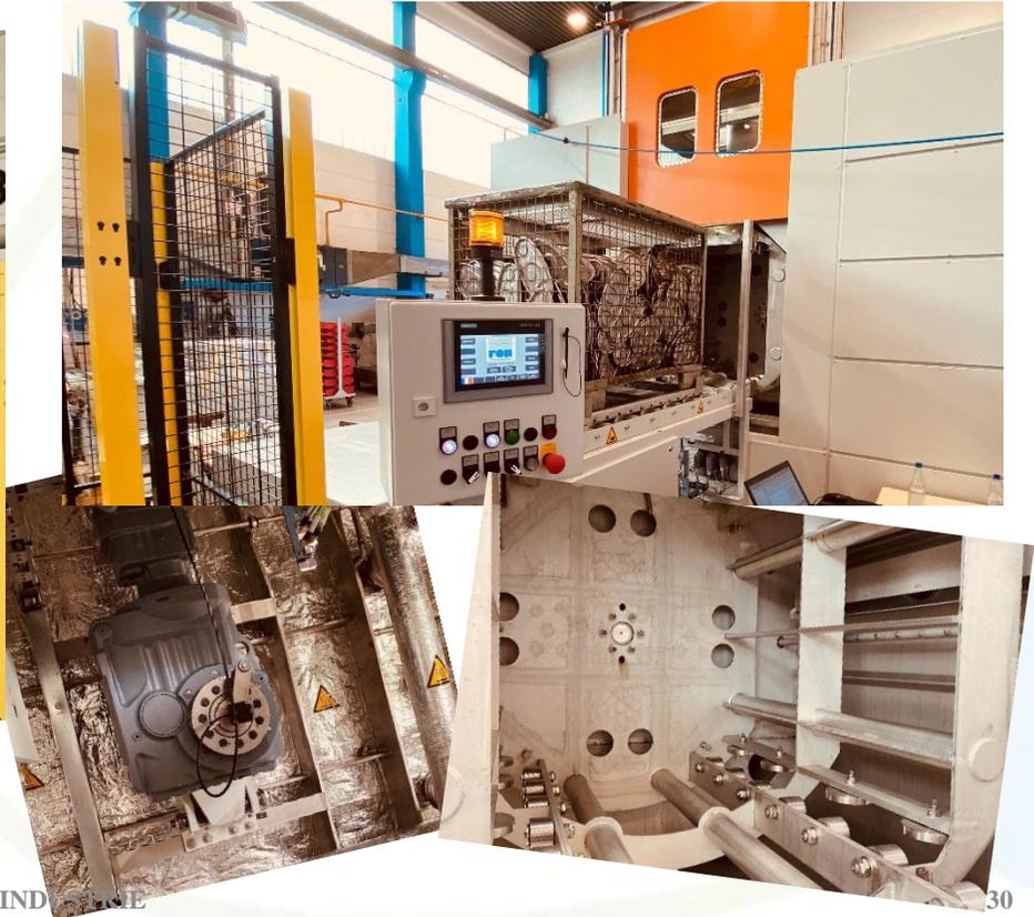
**MACHINE ROLL A 3 BAINS** par aspersion avec panier tournant en axial et charge de 500 Kg pour la société INTERFRAP LAVAGE
