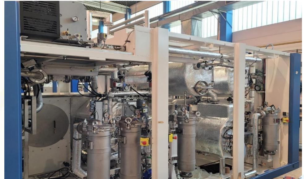
Machine de nettoyage-dégraissage PARTICULAIRE ROLL RCTS 067 avec 2 bains de nettoyage
