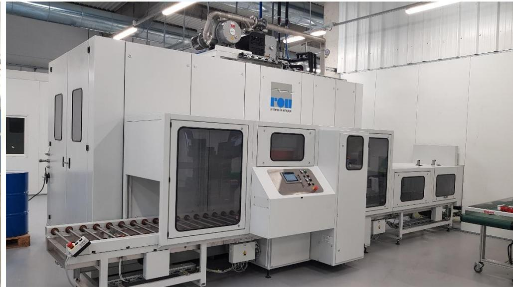
Machine de nettoyage-dégraissage ROLL RCTS 067 avec 2 bains de nettoyage «BONTAZ Centre » au solvant Non Chlore DOWCLENÉ 1601
