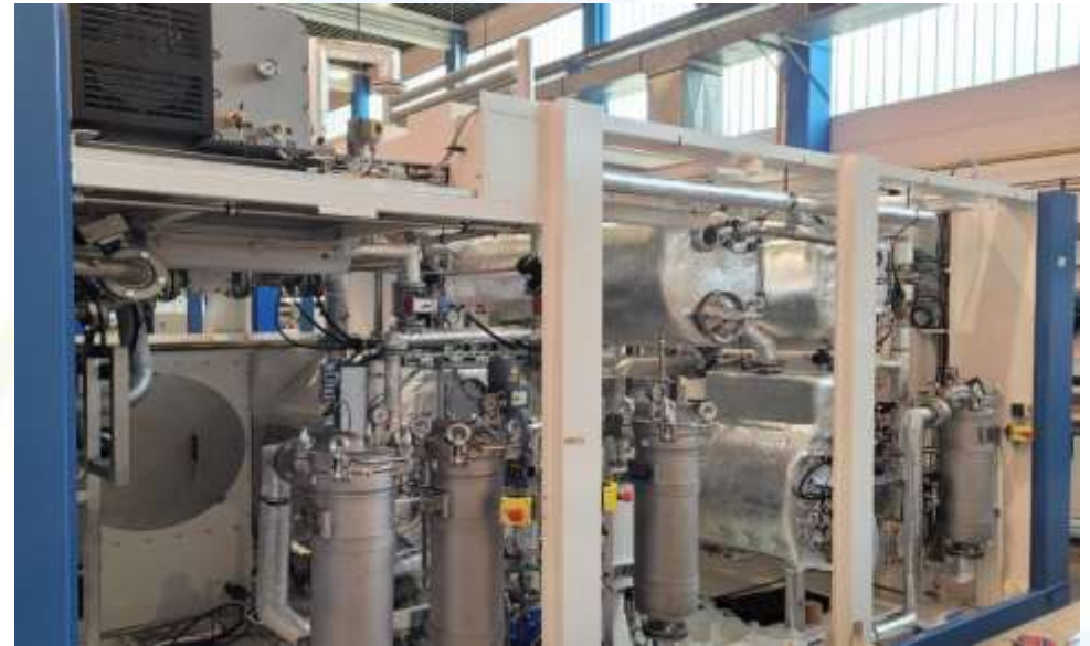
Machine de nettoyage-dégraissage PARTICULAIRE ROLL RCTS 067 avec 2 bains de nettoyage «DEFTA ESSOMES» au solvant Non Chlore RG63 DE GEISS Inclus Double filtration cartouche par bain, distillation en continu
