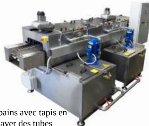
Tunnel à 5 bains à tapis pour laver des pièces découpées
