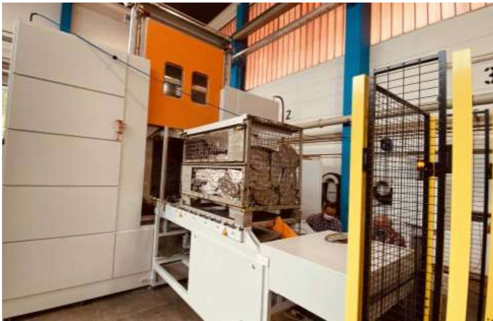
MACHINE ROLL A 3 BAINS par aspersion avec panier tournant en axial et charge de 500 Kg pour la société INTERFRAP LAVAGE
