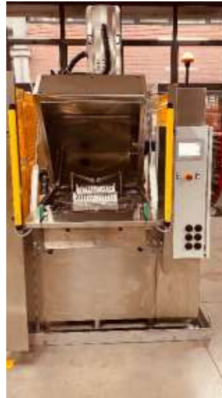
Machine de dégraissage et nettoyage particulaire spéciale en LESSIVIEL UNIX80 2 BAINS « JTEKT HPI » avec ouverture et fermeture automatique
