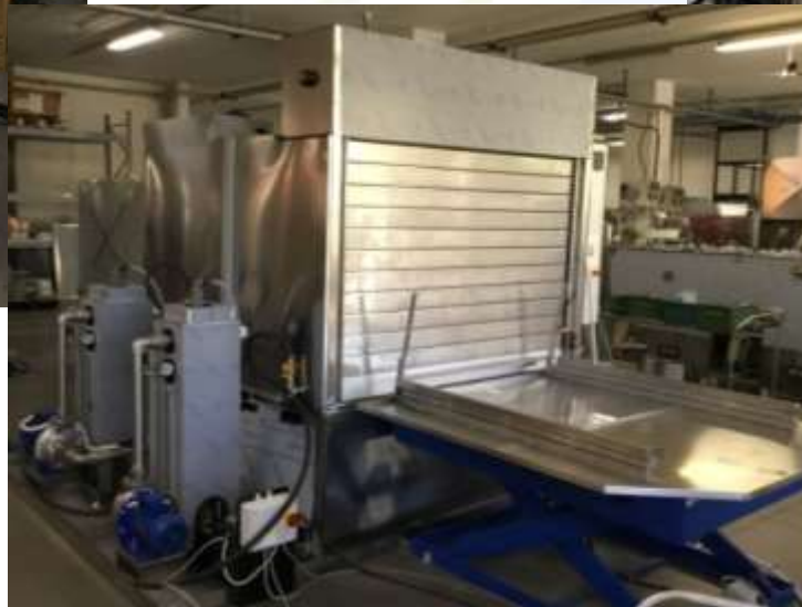
Machine cabine à 2 niveaux pour lavage de divers bacs chez VALEO
