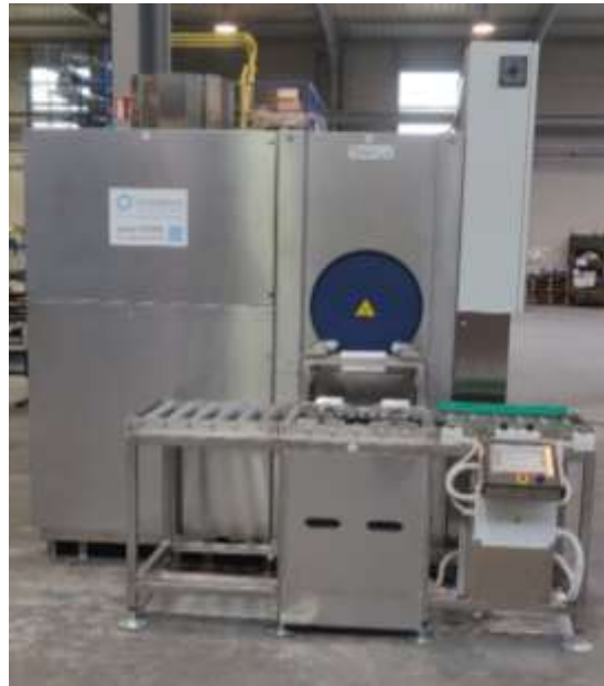
Machine ROTOR TEKNOX LESSIVIEL 1 à 3 BAINS A panier ROTATIF Par aspersion et/ou immersion
