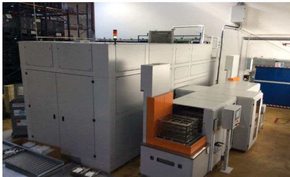
Machine de nettoyage-dégraissage particulaire ROLL RCTS 067 avec 2 bains de nettoyage et 2 bains de regraissage « BORG WARNER » au solvant Non Chlore DOWCLENÉ 1601
