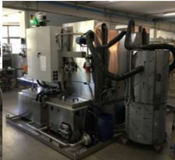
MACHINE SIMPLEX 1800- 2 BAINS avec panier rotatif
