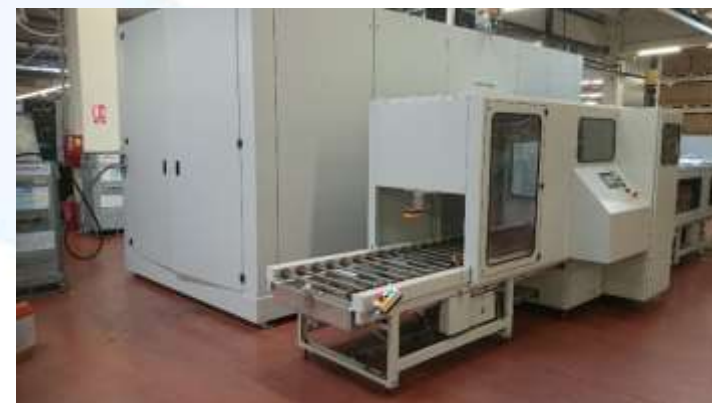
Machine de nettoyage-dégraissage ROLL RCTS 067 avec 2 bains de nettoyage et un bain de dégraissage STREIT Mécanique au solvant Non Chlore DOWCLENÉ 1601
