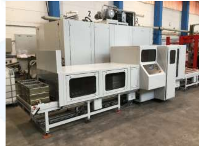
Machine de nettoyage-dégraissage PARTICULAIRE ROLL RCTS 100 avec 2 bains de nettoyage « LEMAN INDUSTRIE » au solvant Non Chlore RG63 DE GEISS
