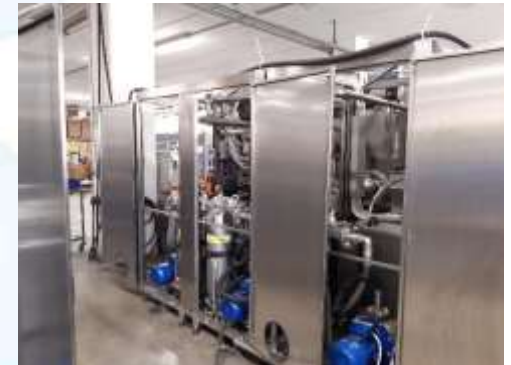
Pompe indépendante d'aspersion et de brassage renforcé
