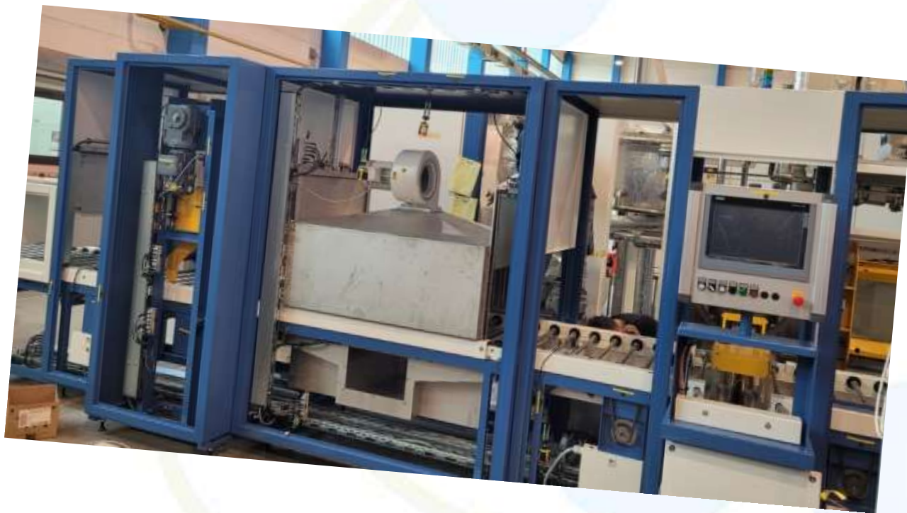
Machine de nettoyage-dégraissage PARTICULAIRE ROLL RCTS 067 vue convoyeur sans carénage
