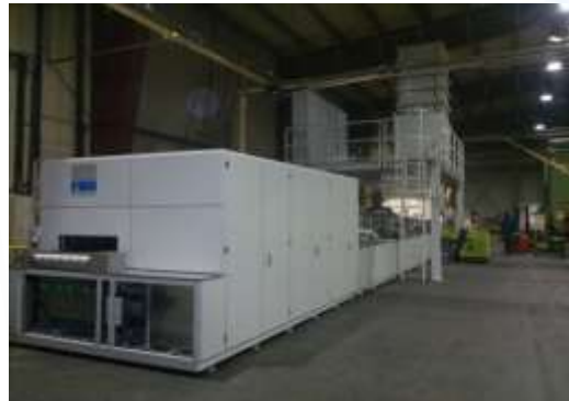
Tunnel à 5 bains à tapis pour laver des pièces découpées
