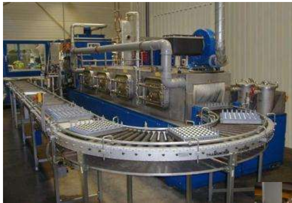
Tunnel à plusieurs baigns dédié pour le lavage de pièces en plateaux
