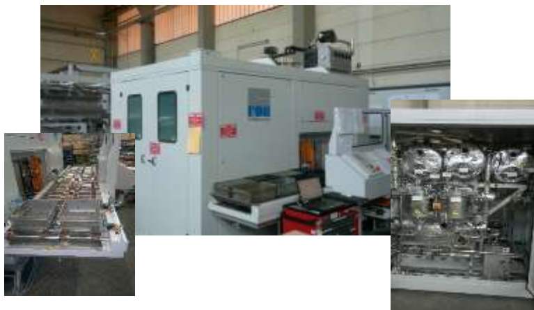
Machine de nettoyage-dégraissage ROLL RCTS 048 avec 2 bains de nettoyage et 1 bain de regraissage « EASYTURN » au solvant Non Chlore DOWCLEN 1601 MACHINE TRAVAILANT EN DECOLLETAGE AVEC 2 PANIERS NOVEL
