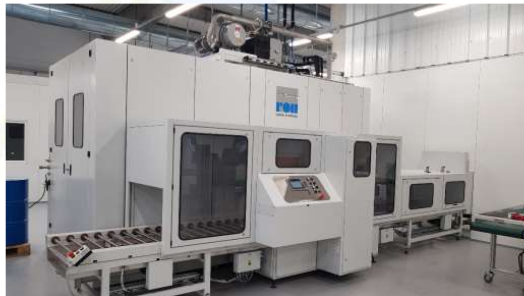
Machine de nettoyage-dégraissage ROLL RCTS 067 avec 2 bains de nettoyage «BONTAZ Centre » au solvant Non Chlore DOWCLENÉ 1601
