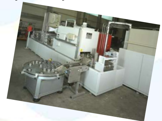
Tunnel à 5 bains à tapis pour laver des pièces découpées
