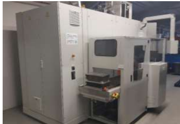
Machine de nettoyage-dégraissage PARTICULAIRE ROLL RCTS 048 avec 2 bains de nettoyage « LEGENDRE TECHNIC » au solvant Non Chlore RG63 pour 2 paniers NOVEL
