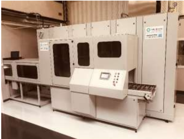
Machine de nettoyage-dégraissage PARTICULAIRE ROLL RCTS 048 avec 2 bains de nettoyage « METALIS » au solvant Non Chlore DOWCLEN 1601 AVEC ENTREE EN SALLE BLANCHE
