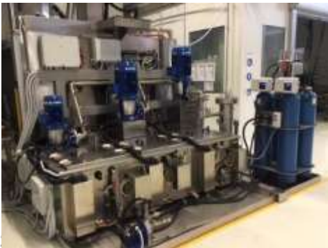
MACHINE cabine 3 BAINS de diamètre 2600 mm : lavage à 25 bars rinçage 1 à 15 bars Rinçage 2 à 10 bars en eau deminéralisée panier rotatif, rampe Centrale pour lavage de carter en aéronautique
