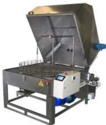
Machine SZD a décantation 1 bain
