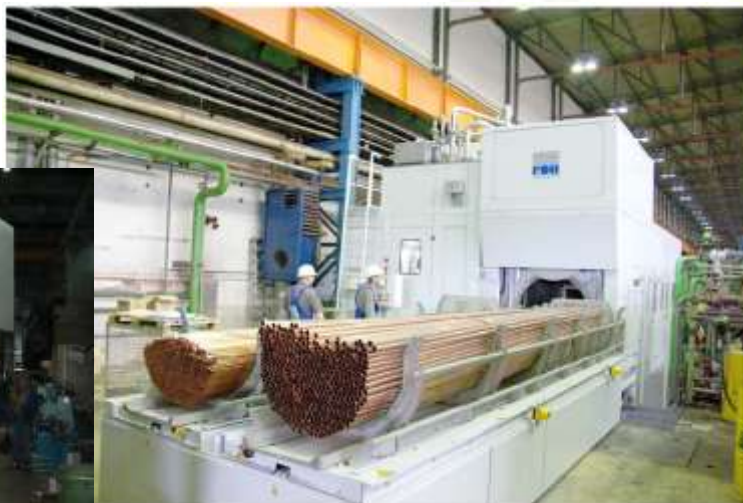
Equipement de lavage RWTVS 800 Panier de 8000*600*600 mm
