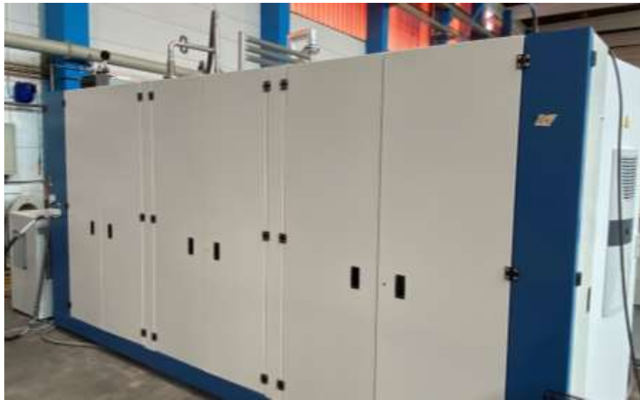
Machine de nettoyage-dégraissage PARTICULAIRE ROLL RCTS 067 avec 2 bains de nettoyage «DEFTA ESSOMES» au solvant Non Chlore RG63 DE GEISS Inclus Double filtration cartouche par bain, distillation en continu
