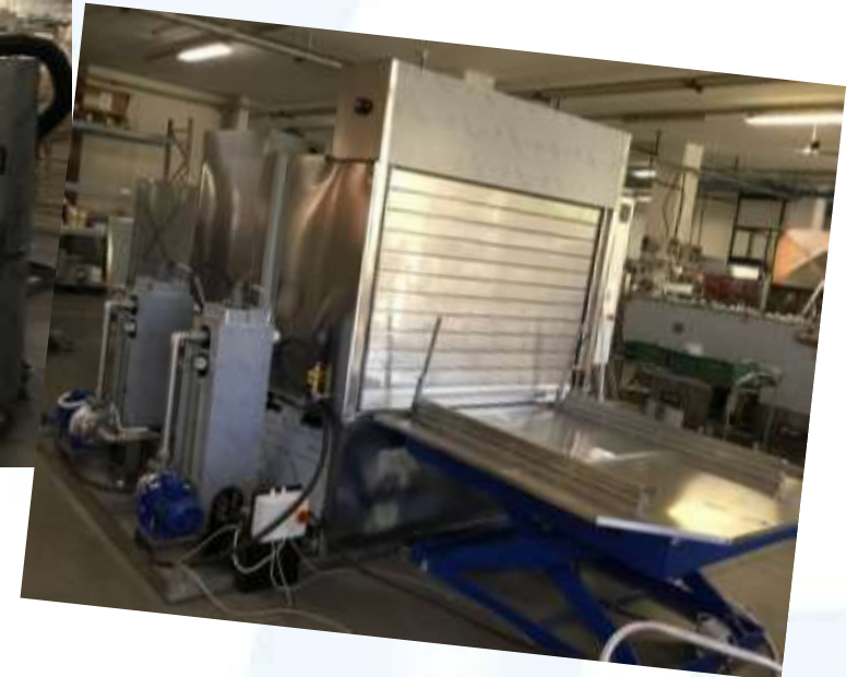
MACHINE SIMPLEX BIG 1800 VUE COTE FILTRE ET POMPES;
