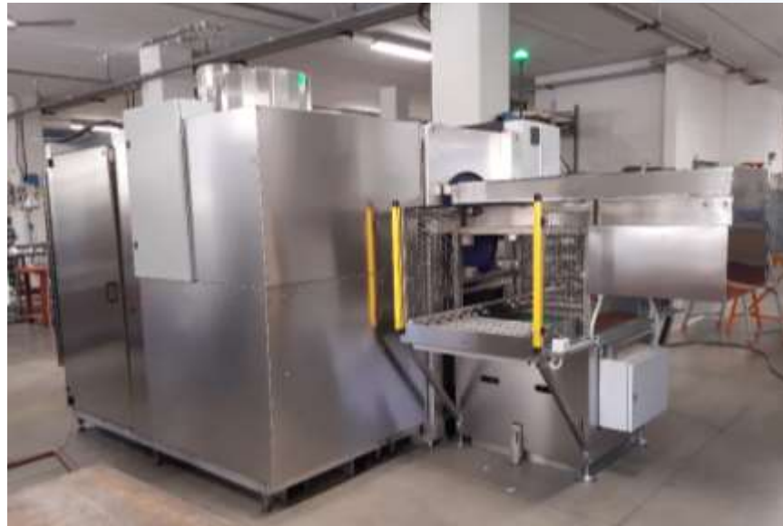
Machine de dégraissage et nettoyage particulaire en LESSIVIEL ROTOR M 3 bains « JTEKT HPI » avec convoyage semi automatique
