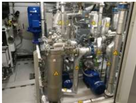
Pompe haute pression d'aspersion et de brassage sur tous les bains
