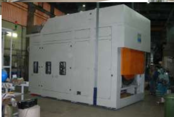
Equipement de lavage RCTS 170 PHASE VAPEUR Panier de 1700*1000*1000 mm
