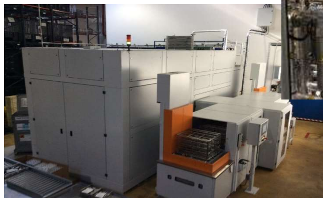
Machine de nettoyage-dégraissage ROLL RCTS 067 avec 2 bains de nettoyage et 2 bains de regraissage « BORG WARNER » au solvant Non Chlore DOWCLENÉ 1601
