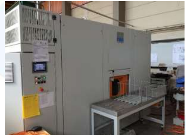
Machine de nettoyage-dégraissage ROLL RCTS 50 avec 2 bains de nettoyage « AEDS » au solvant Non Chlore DOWCLEN 1601
