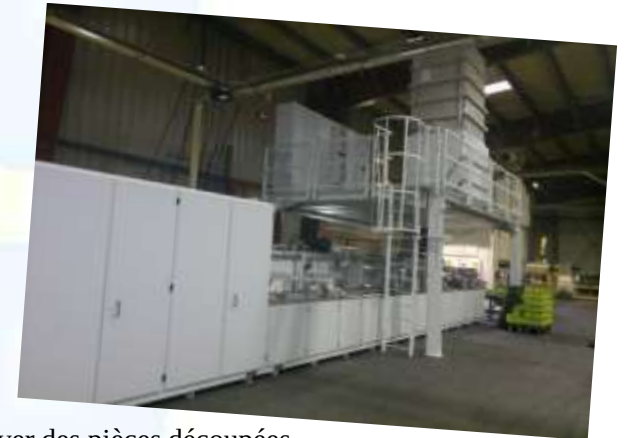
Tunnel à 5 bains à tapis pour laver des pièces découpées
