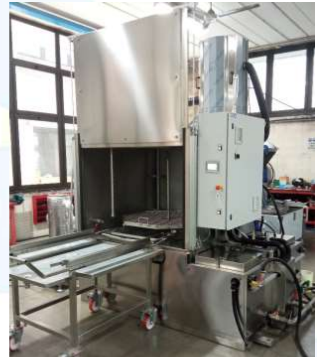
MACHINE SIMPLEX BIG 2 BAINS avec lavage-rinçage intérieur de carter et les circuits hydraulique par circulation pour l'AERONAUTIQUE CLIENT: FUTURA MECANIQUE
