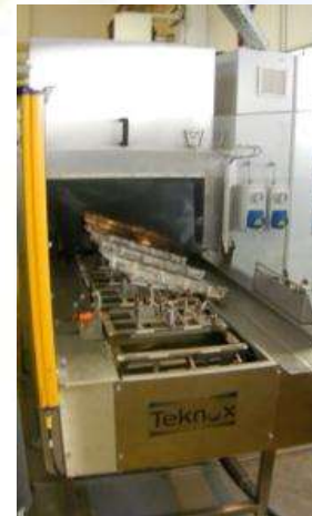
Tunnel à 3 bains dédié avec pièces positionnées pour nettoyage particulaire « LEBELIER »
