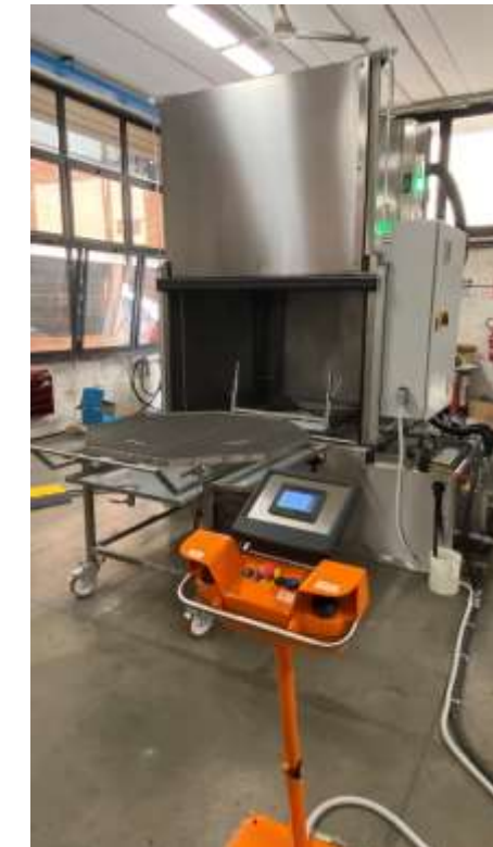
Machine de lavage en 2 baignoires des outillages pour la fabrication des réservoir D'Hydrogène
