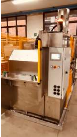
Machine de dégraissage et nettoyage particulaire spéciale en LESSIVIEL UNIX80 2 BAINS « JTEKT HPI » avec ouverture et fermeture automatique
