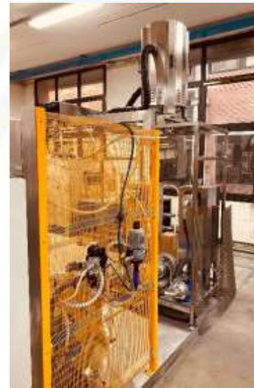
Machine de dégraissage et nettoyage particulaire spéciale en LESSIVIEL UNIX80 2 BAINS « JTEKT HPI » avec ouverture et fermeture automatique
