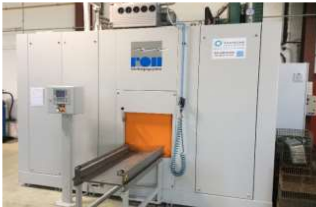
Machine de nettoyage-dégraissage ROLL RCTS 120 avec 2 bains de nettoyage « CONTROREM » au solvant Non Chlore DOWCLEN 1601
