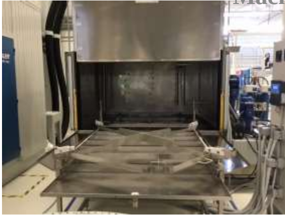
MACHINE cabine 3 BAINS de diamètre 2600 mm : lavage à 25 bars rinçage 1 à 15 bars Rinçage 2 à 10 bars en eau deminéralisée panier rotatif, rampe Centrale pour lavage de carter en aéronautique
