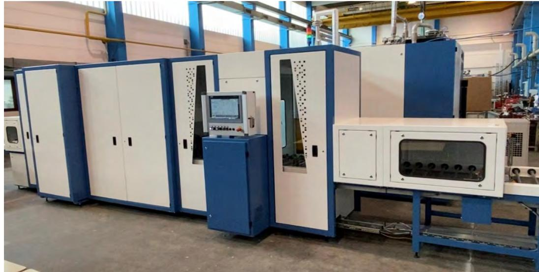
Machine de nettoyage-dégraissage PARTICULAIRE ROLL RCTS 067 avec 2 bains de nettoyage «DEFTA
