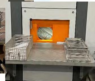
**Machine de nettoyage-dégraissage ROLL RCTS 048 ADVANTAGE avec 2 bains de nettoyage et table de chargement manuelle**
