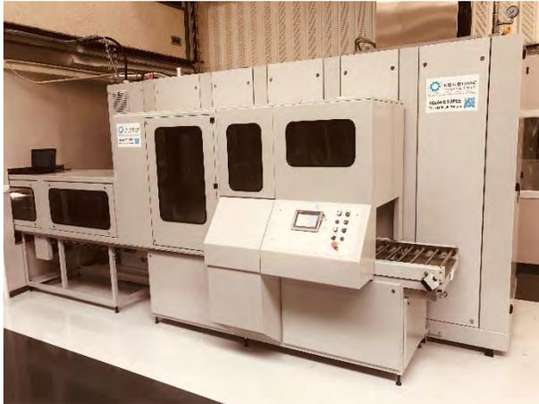
Machine de nettoyage-dégraissage
