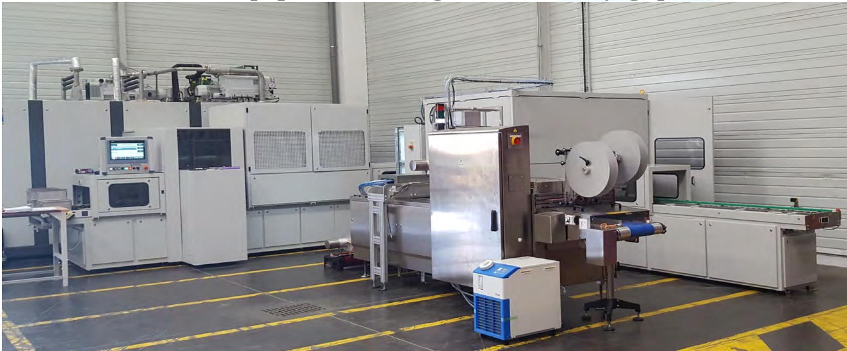
Machine de nettoyage-dégraissage PARTICULAIRE ROLL RCTS 089 avec 2 bains de nettoyage
