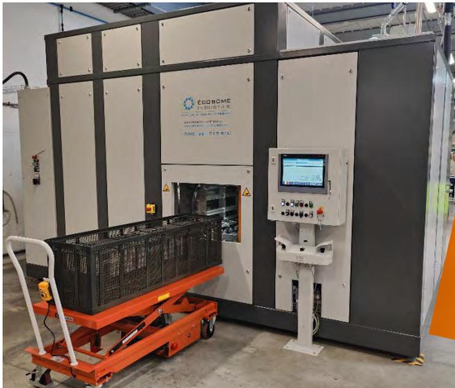
Machine de nettoyage-dégraissage ROLL RCTS 160 avec 2 baignoires de nettoyage
