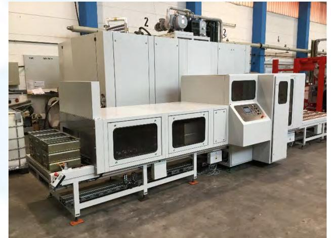
Machine de nettoyage-dégraissage PARTICULAIRE
