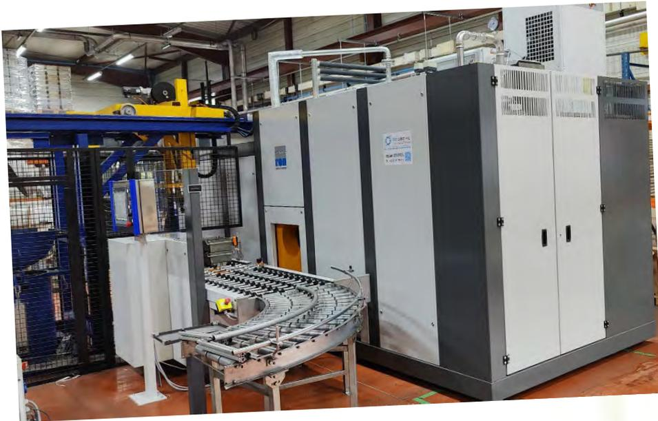
Machine de nettoyage-dégraissage ROLL RCTS 067 avec 2 bains de nettoyage et 1 bain de regraissage « PALUMBO » au solvant Non-Chlore DOWCLENE 1601
