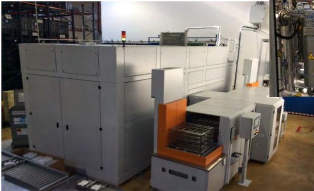
Machine de nettoyage-dégraissage ROLL RCTS 067 avec 2 bains de nettoyage et 2 bains de re graissage
