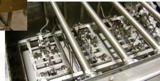
Tunnel ovale dédié avec pièces positionnées pour nettoyage particulaire
