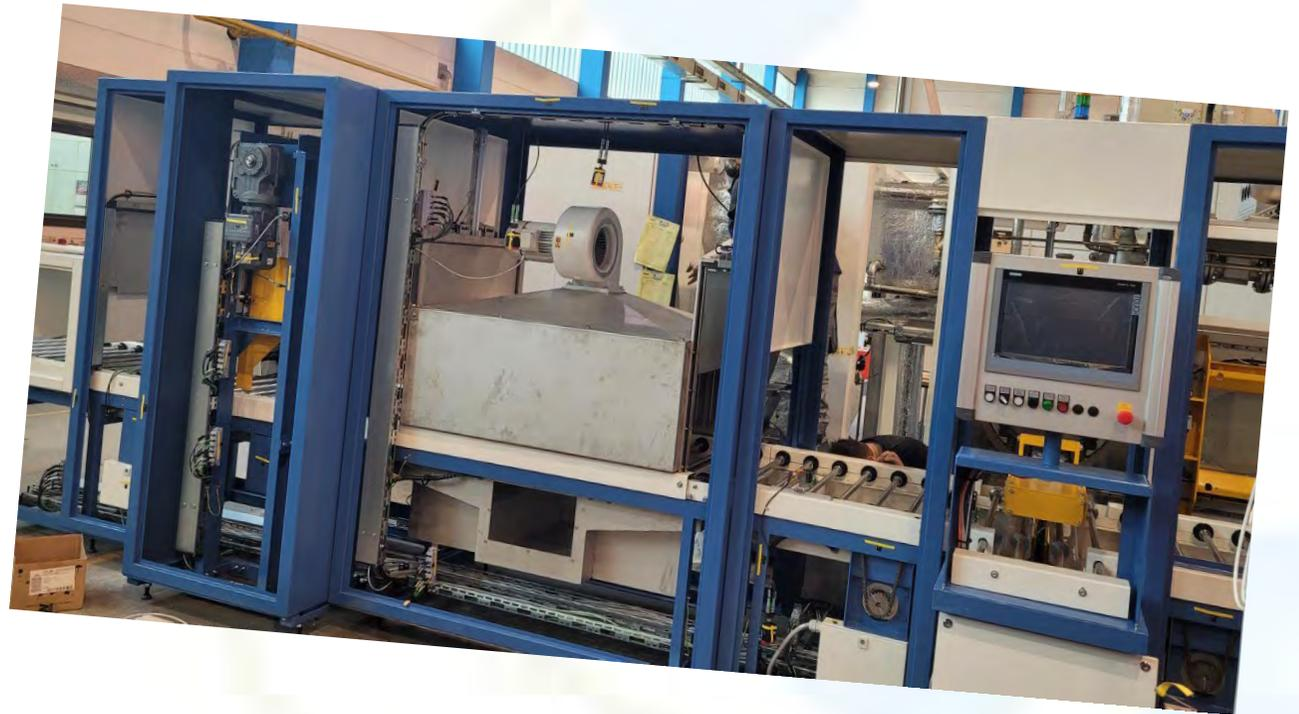
Machine de nettoyage-dégraissage PARTICULAIRE ROLL RCTS 067 vue
