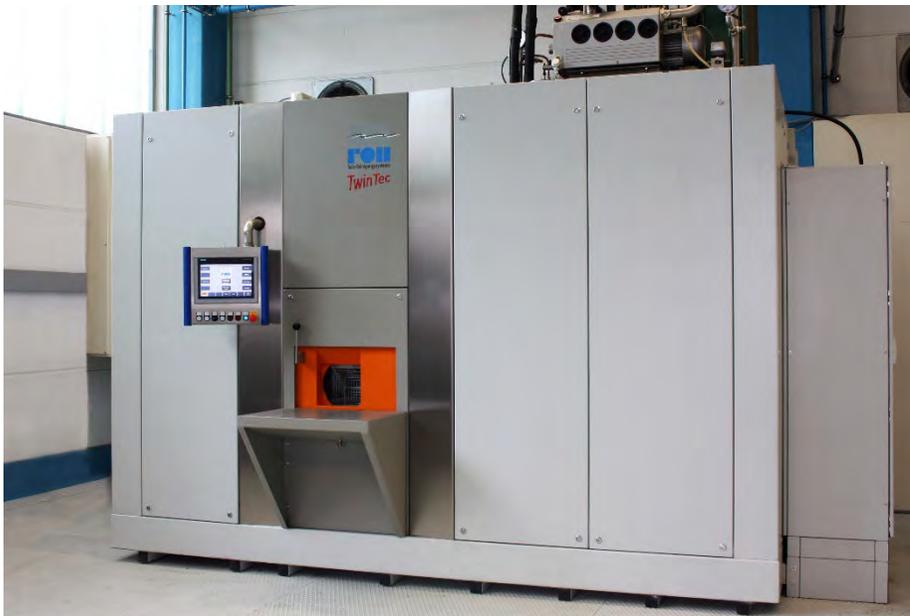
Nouvelle machine **TWINTEC** appropriée pour le lavage combiné solvants et lessives. Ces produits sont employés dans la même chambre de lavage avec un processus défini et adapté à chaque client
