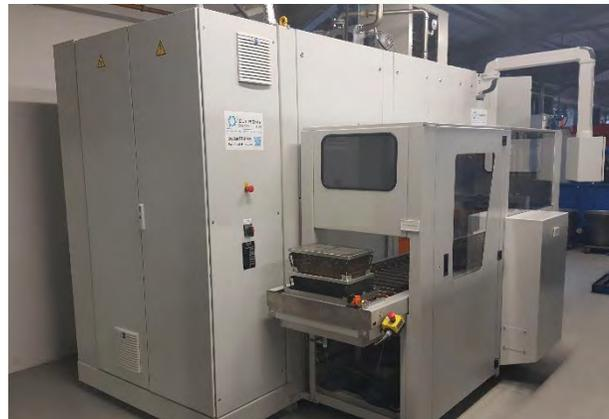
Machine de nettoyage-dégraissage
