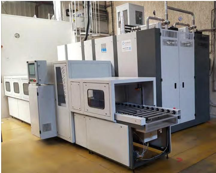
Machine de nettoyage-dégraissage particulaire ROLL RCTS 067 avec 2 bains de « METALIS » au solvant Non-Chlore DOWCLENE 1601
